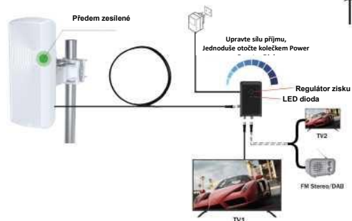
Instalace 2: Připojené pomocí set-top boxu (Obr.7)
